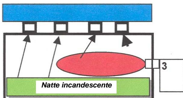
**Montage:** c'est à recommander en cas des chaudières en fonte, si des plusieurs tirages (cheminées) sortent successivement de la chambre. La natte doit couvrir le fond de la chambre complètement et couvre aussi les côtés si haut que possible. Pourtant, les sorties de gaz brûlés ne doivent pas être bouchés.
