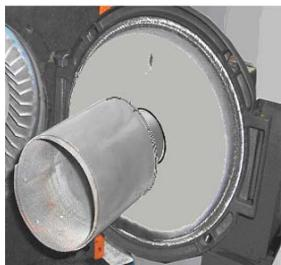
**ZVP-Rohr zur Senkung der Abgastemperatur, Erhöhung der CO<sub>2</sub>-Werte, Verringerung der Rußzahl.**
