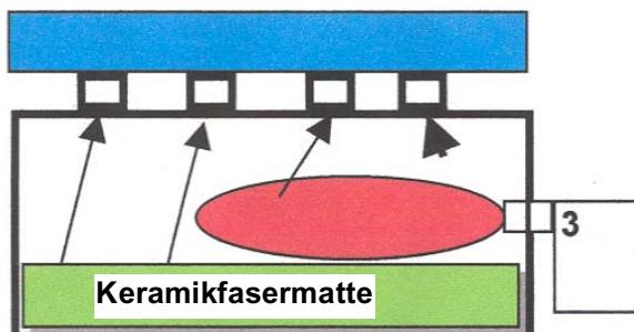
**Einbau der Keramikfasermatte:** die Matte muss den kompletten Brennkammerboden und seitlich so hoch wie möglich verlegt sein, jedoch dürfen die Züge nicht verdeckt werden.
