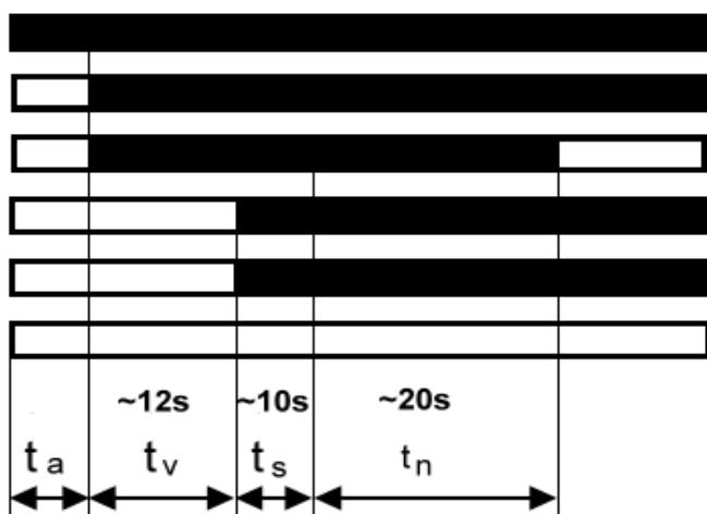
Ölvorwärmung / Oil preheating / Préchauffage du fuel
