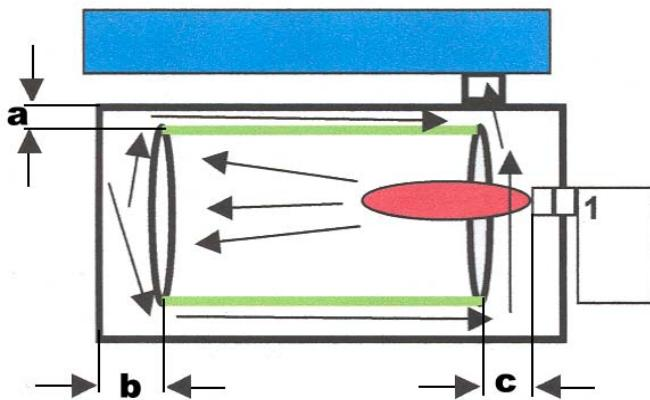
**Einbau:** Glührohreinsatz in die Brennkammer einbauen, die nebenstehenden Mindestmasse einhalten. Die Flamme muss sich in der Mitte des Glührohres befinden.
