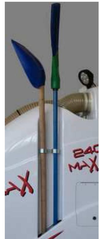
Support pelle et balai intégré dans le composite (de série)
