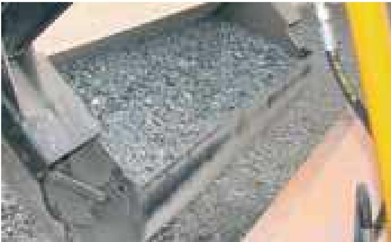
Capacité du bac de ramassage 350 l soit 450 kg de gravier
