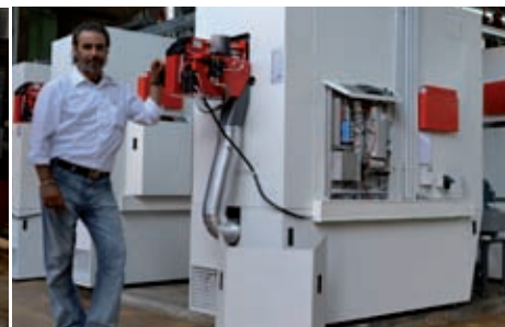
La technologie à Condensation Permanente assure l'utilisation entière d'énergie du procès de condensation sans interruptions, même avec les températures des eaux de retour élevées. A droite : Michael Gillé, Conseil Technique, est visiblement satisfait de la projection et de l'exécution.
