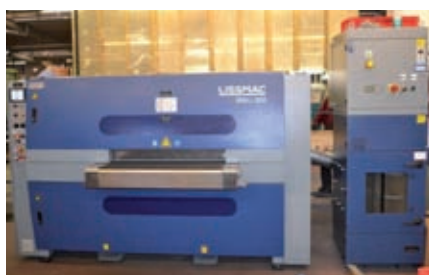
En haut : la machine d'ébarbage nouvelle. Grâce aux machines nouvelles, Kroll est à même de travailler des grands formats sans problème.
